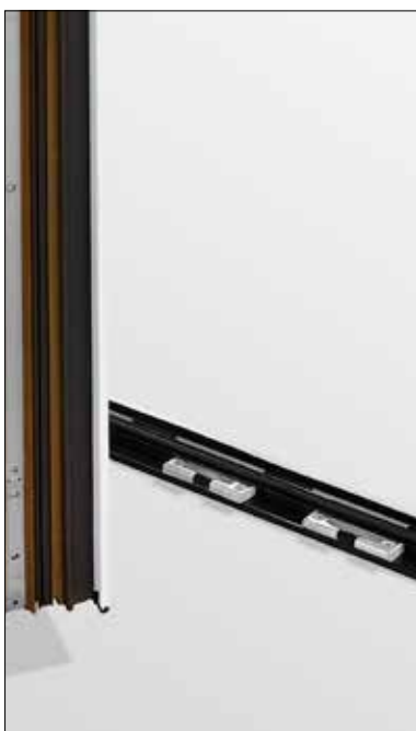
Soglia ribassata portafinestra a taglio termico con doppio riscontro antieffrazione.
